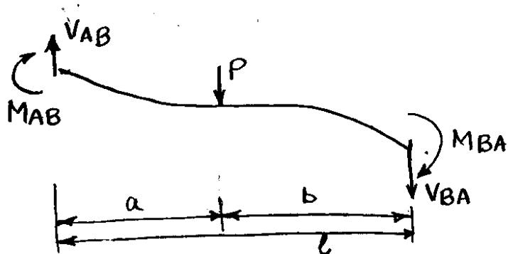
$$V_{AB} - P - V_{BA} = 0 \rightarrow$$
